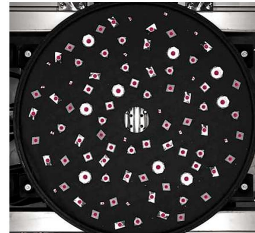
AI는 회선식 인서트의 외형 윤곽을 정확히 인식하고, 새로운 제품조차도 정상(OK)과 불량(NOK)을 정확히 구별해낸다. (이미지: Xactools GmbH)
